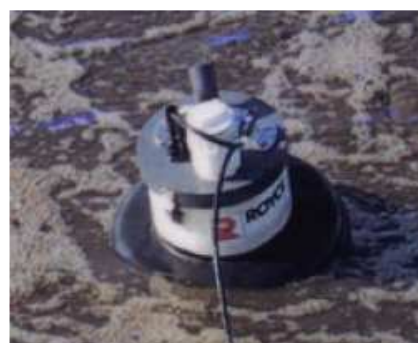
Bouée support capteur Nettoyage automatique Étalonnage automatique Précision de mesure constante Aucune dérive due à l'encrassement
