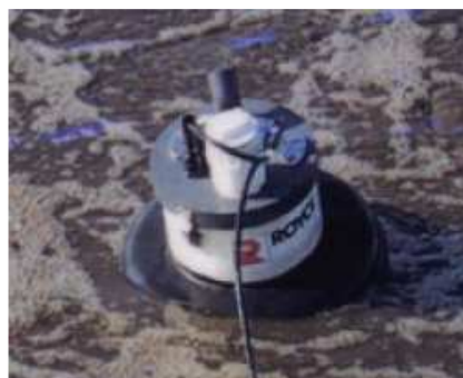
Bouée support capteur Nettoyage automatique Etalonnage automatique Précision de mesure constante Aucune dérive due à l'encrassement
