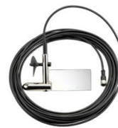
Capteur suspendu lesté avec hélice eau Ø 60 et 15 m de câble (cours d'eau)
